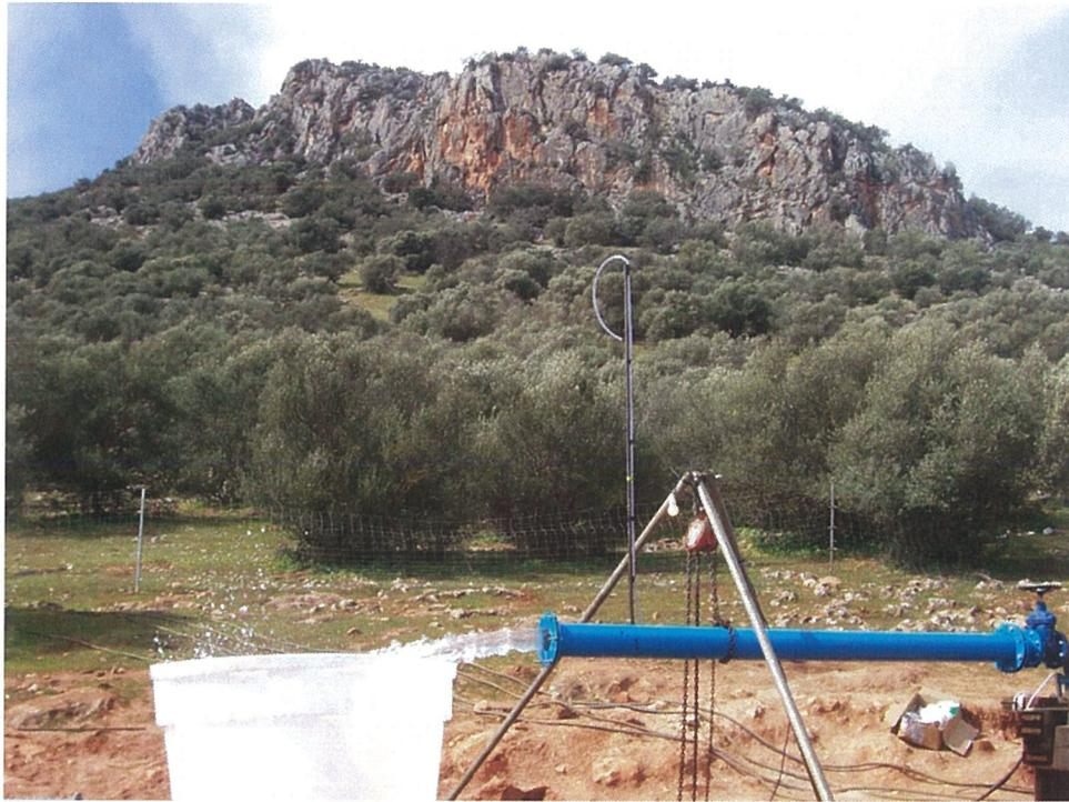
Foto nº 3. Detalle del aforo realizado en el Algaidlla III ( caudal = 32 l/s)
