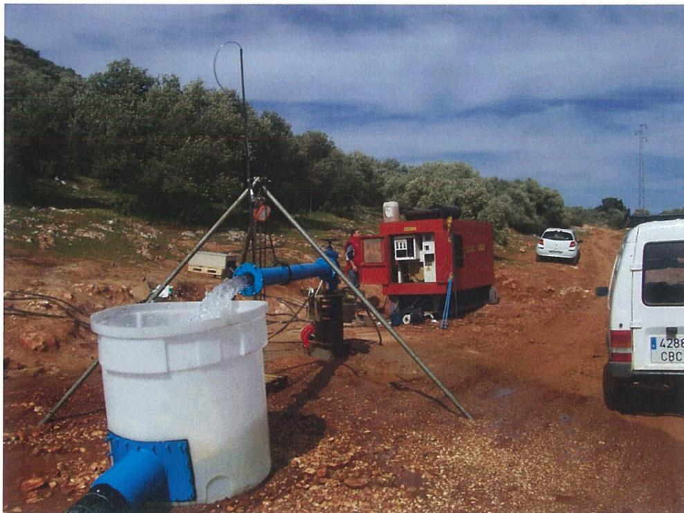
Foto nº 4. Detalle del sistema de evacuación de agua para eliminar el efecto de reciclado
