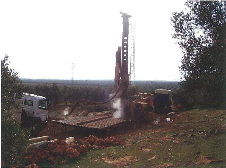
Foto nº 1. Detalle del equipo de perforación del sondeo Algaidlla III, en Estepa (Sevilla)
